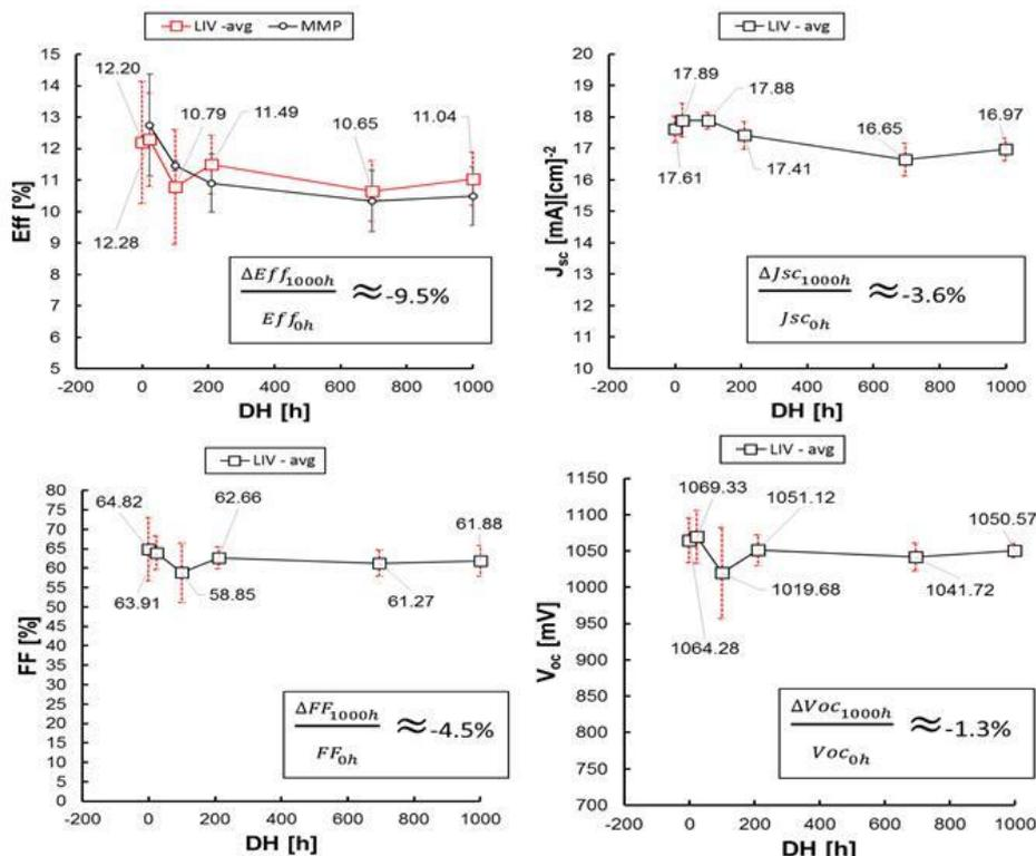
Figure 18. Degradation of perovskite mini module of CSEM.
