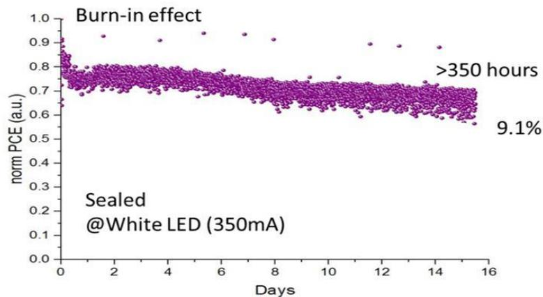
Figure 17. Degradation of perovskite mini module of CHOSE.
